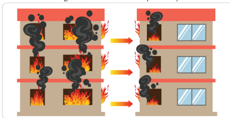
Figura 6 - Transmissão de calor por irradiação
