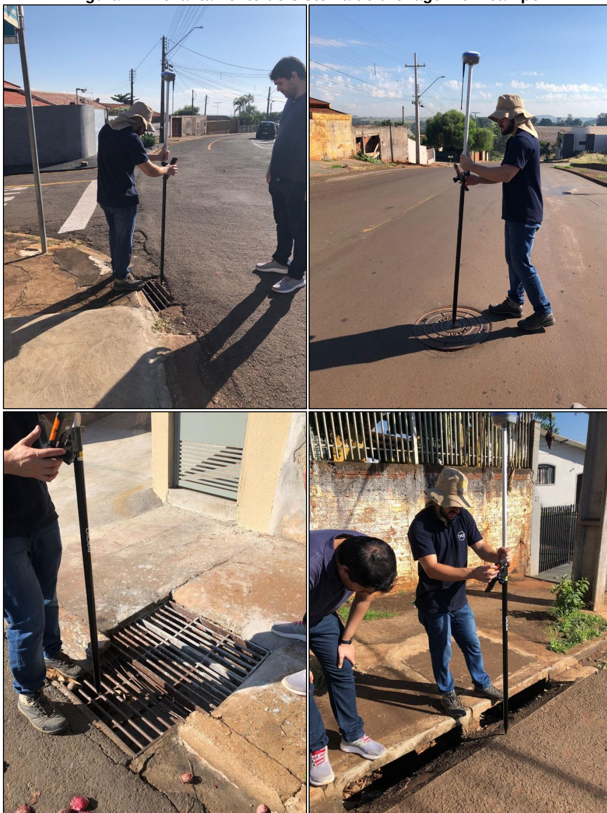
Figura 2 – Levantamento do sistema de drenagem em campo.
