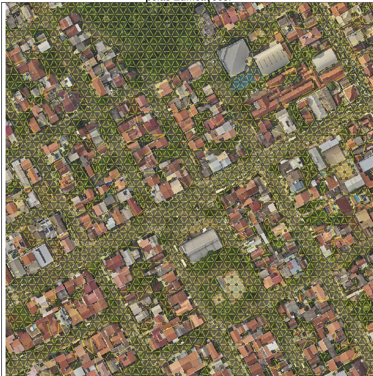
Figura 14 – Malha de Drenagem Superficial com as Deformações Geradas pelas Edificações.
